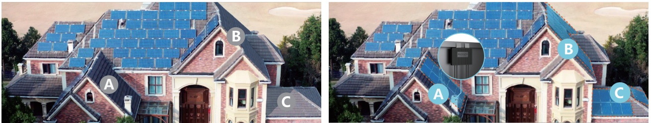
加装优化器后可多安装遮阳区域 A/B/C 模块
